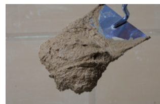
↑ richtige Konsistenz des Fugenfixes ↑
